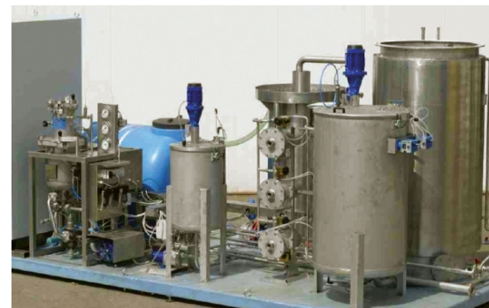
Pilotna naprava za AOP/bio čiščenje tekstilnih odpadnih vod, izdelana v okviru EU projekta ADOPBIO
